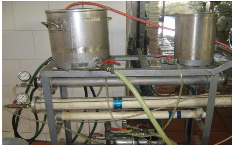
Figura 1. Planta piloto de ultrafiltración y nanofiltración.
